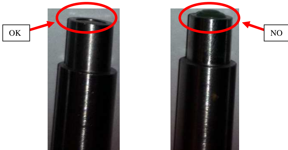
Figura 1 – Attuatore elettrovalvola con tenuta di dimensioni normali (immagine di sinistra) e con la tenuta rigonfiata (immagine di destra) dopo aver reagito con una miscela non conforme di R134a
